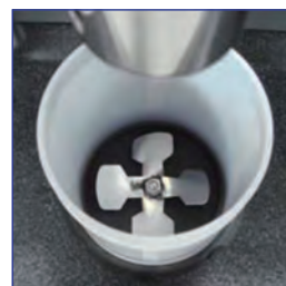
サンプルカップ底の攪拌用プロペラ
