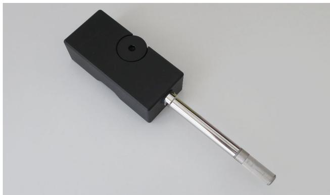
ステンレス製ネットフィルタ付きHMP371プローブ
