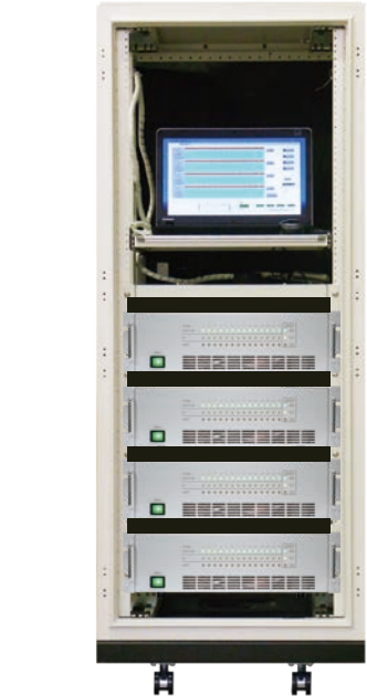
※写真は14ch×4Unitの56chPMSラックシステム
