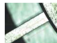
垂直落射照明により確実なエッジ検出
