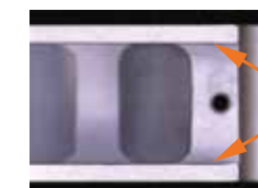
段差部のエッジ測定（高分解能モード）
