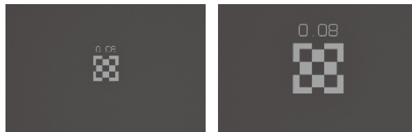
タレット1x 視野2.49×1.86 mm タレット2x 視野1.24×0.93 mm
