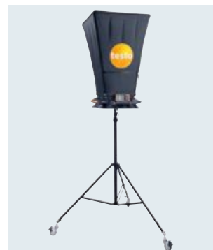
折りたたみ式のキャスター付き三 脚、通気口が高い場所(天井高4mま で)でも安全に測定可能
