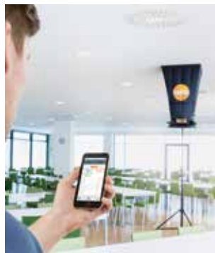
Bluetoothによるアプリ通信でモバ イル端末に測定データを表示、現場 で測定レポートを作成・送信可能
