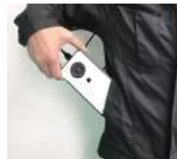
データ解析時はポケットに入るバッテリーパック付端末 (310g) だけ携帯します。
