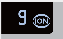
動作中はLEDランプが点灯 IONキーを押すと除電開始、除電中は{ION}のマークが点灯
