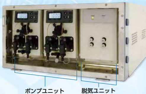
ポンプユニット 脱気ユニット
