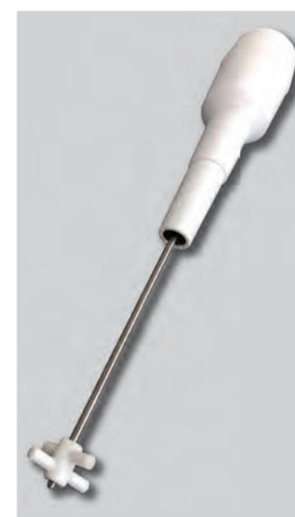
電極ホルダとともに試料容器にセットしたプロペラスターラー
