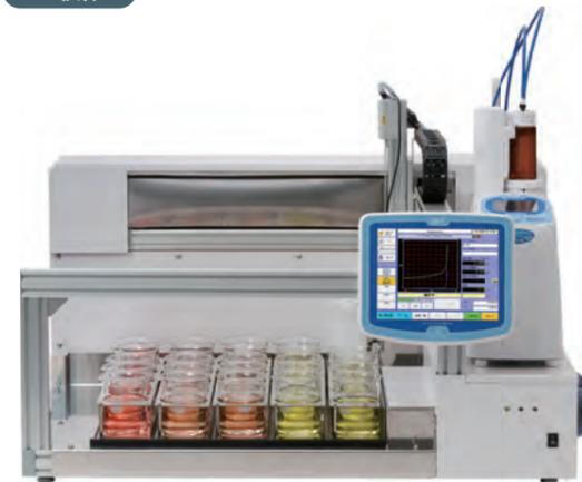
堅牢な筐体と高い位置精度を持つニアアクチュエータを採用した3軸駆動ロボット型の多検体チェンジャです。試料容器を試料カートリッジに並べ、多検体チェンジャにセットします。試料カートリッジは、複数の試料が入っていても運びやすい構造になっており、「多検体チェンジャに直接試料容器をセットする方法」と、「多検体チェンジャと設置場所が異なる場所で用意した
