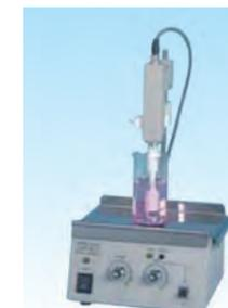
界面活性剤、高分子凝集剤および塗料や食品に含まれる高分子の荷電粒子がコロイド状に分散している試料を反対の荷電のコロイド試薬で滴定し、流動電位の変化によりコロイド当量点を検出するユニットです。
