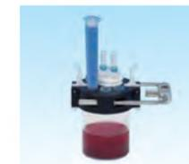
揮発性が高く、大気開放下では正確に測定することができない場合に用いる密閉型の滴定セルユニットです。滴定セル内を窒素ガスなどでパージすることも可能です。
