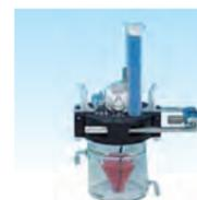
試料が非常に少量の場合に用いる滴定セルユニットです。滴定セルは密閉構造で、恒温水循環用ジャケットが付いています。最少1mLで測定できます。
