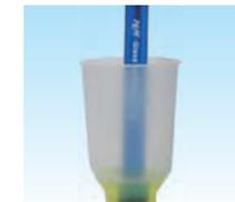
試料量10mLで測定することができる専用容器です。滴定液は50mLまで注入することができます。希釈できない試料に最適です。
