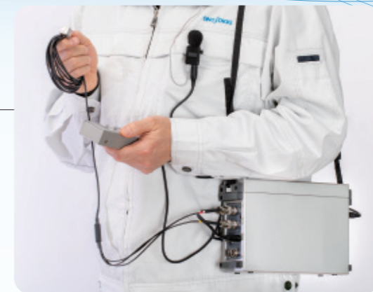
加速度検出器、イヤホンマイク、リモートコントローラ接続の様子。
