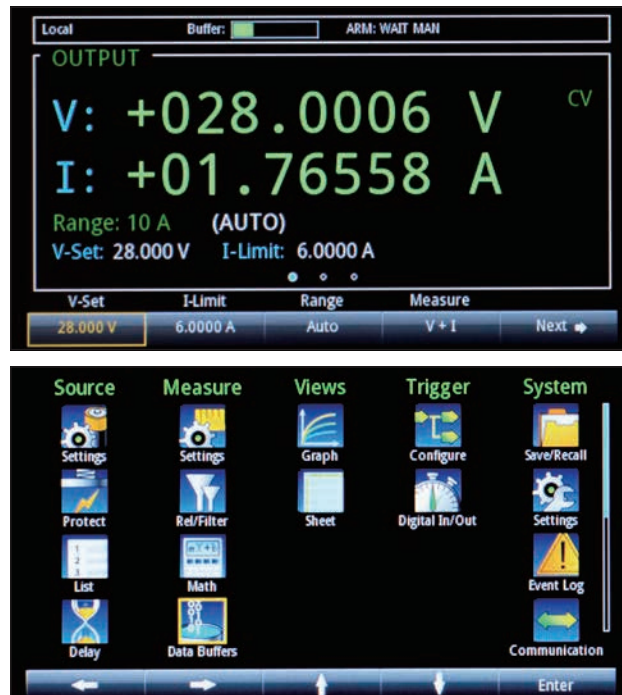
図3. ホーム画面上から電圧、電流、電流レンジ、測定モード、保護レベル、その他の機能を調整可能
