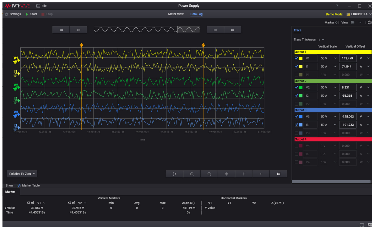
図3. PC用PathWave BenchVueソフトウェアによるデータロギング
