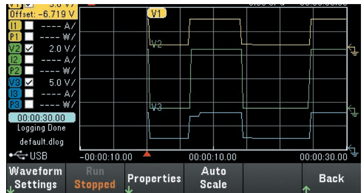
図1. 「データ・ロガー・ビュー」では、複数のデータを記録できます。この図では、出力1、出力2、出力3の電圧を30秒間捕捉しています。
