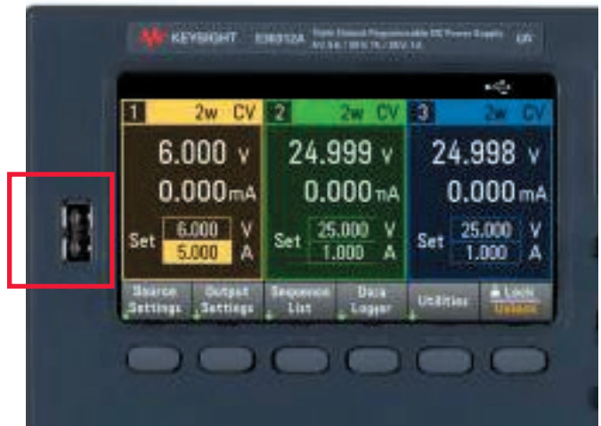
図7. フロントパネルのUSBポート
