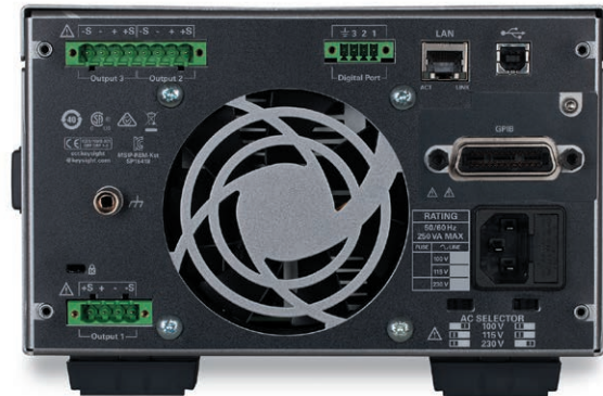
図6. すべてのチャンネルの出力端子がリアパネルにもあるので、システムのセットアップに便利
