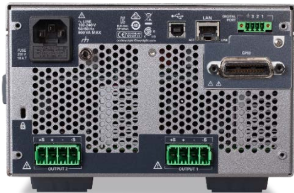
図5. ベンチとシステムのセットアップで容易な配線を可能にする背面の出力端子
