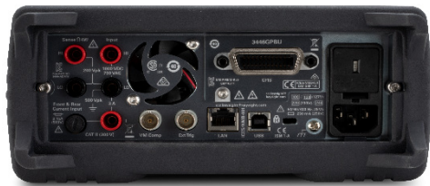
34461/65/70A DMMリアパネル（GPIBオプション搭載）。
