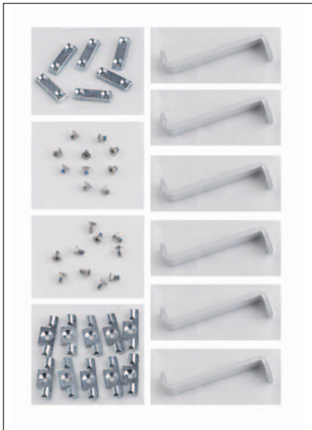
34194A デュアルロック・リンク・キット： 複数の測定器を並べて連結する場合に使用しま す。奥行きの異なる測定器を連結する金具が付 属します。34191A 2Uデュアル・フランジ・キ ットと組み合わせれば、高さ2U、1/2幅の測定 器を2台横に並べてマウントできます。
