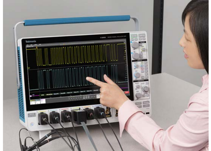
スマホやタブレットと同じ静電容量方式のタッチスクリーンを使用して操作が行える
