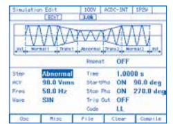
電源変動試験設定
