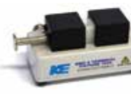
チップテストフィクスチャ 1024* ● 2端子接続 ● 測定周波数 ≤120MHz ● 最小部品サイズ : 0603
