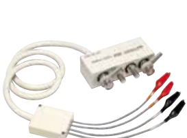
4端子ワニグテックリップ テストリード 2324 ● 4端子接続 ● 測定周波数 ≤100kHz
