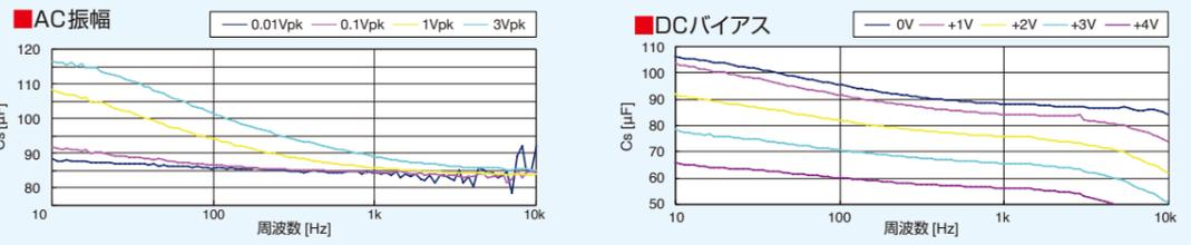
シーケンス機能を使うことで、同じ周波数範囲で、AC振幅やDCバイアスを変更して測定することができます。複数の条件を一回のシーケンスで測定し、結果を一画面表示できます。電圧値により特性が変化する積層セラミックコンデンサ (MLCC) やインダクタ、トランスなどを効率よく測定できます。
