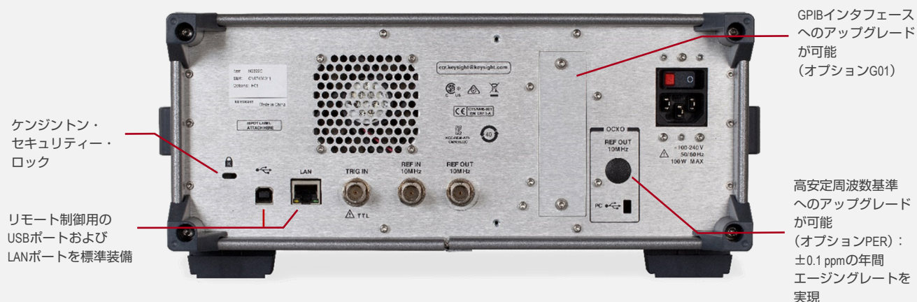
図 5. 932xC スペクトラム・アナライザのリアパネル
