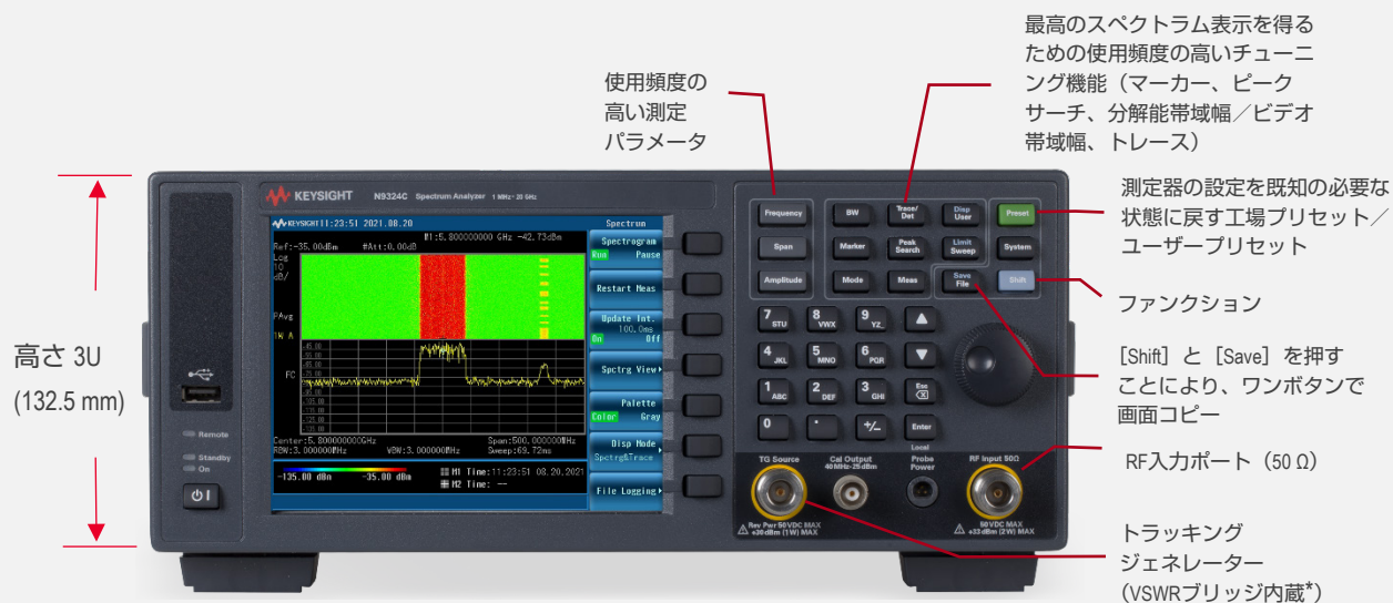
図 4. 9324C BSA スペクトラム・アナライザのフロントパネル
