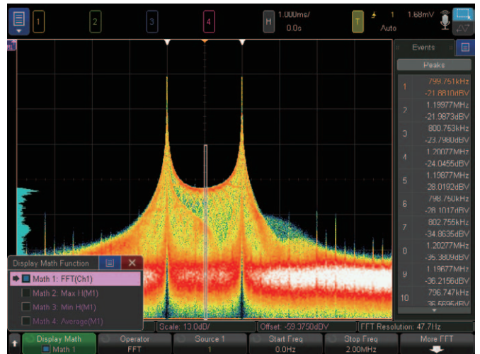
図36. 拡張カラー FFT(自動ピークサーチおよびFFTヒストグラムがオン)。FFT、最小値／最大値ホールド、平均値も使用可能。
