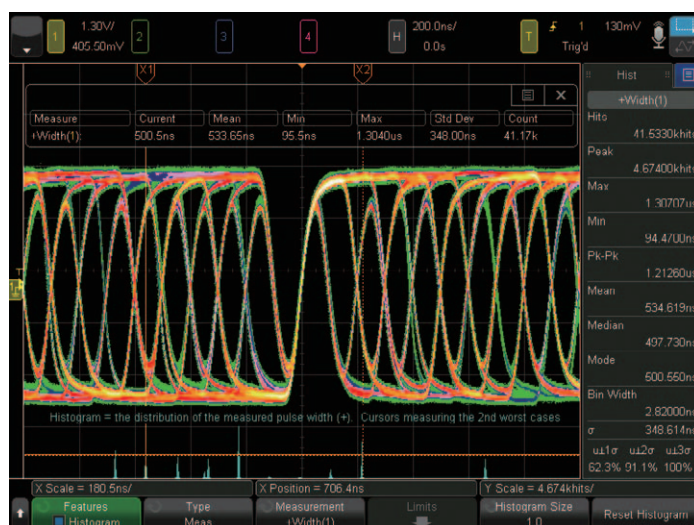
図16b. パルス幅の測定結果のヒストグラム表示。
