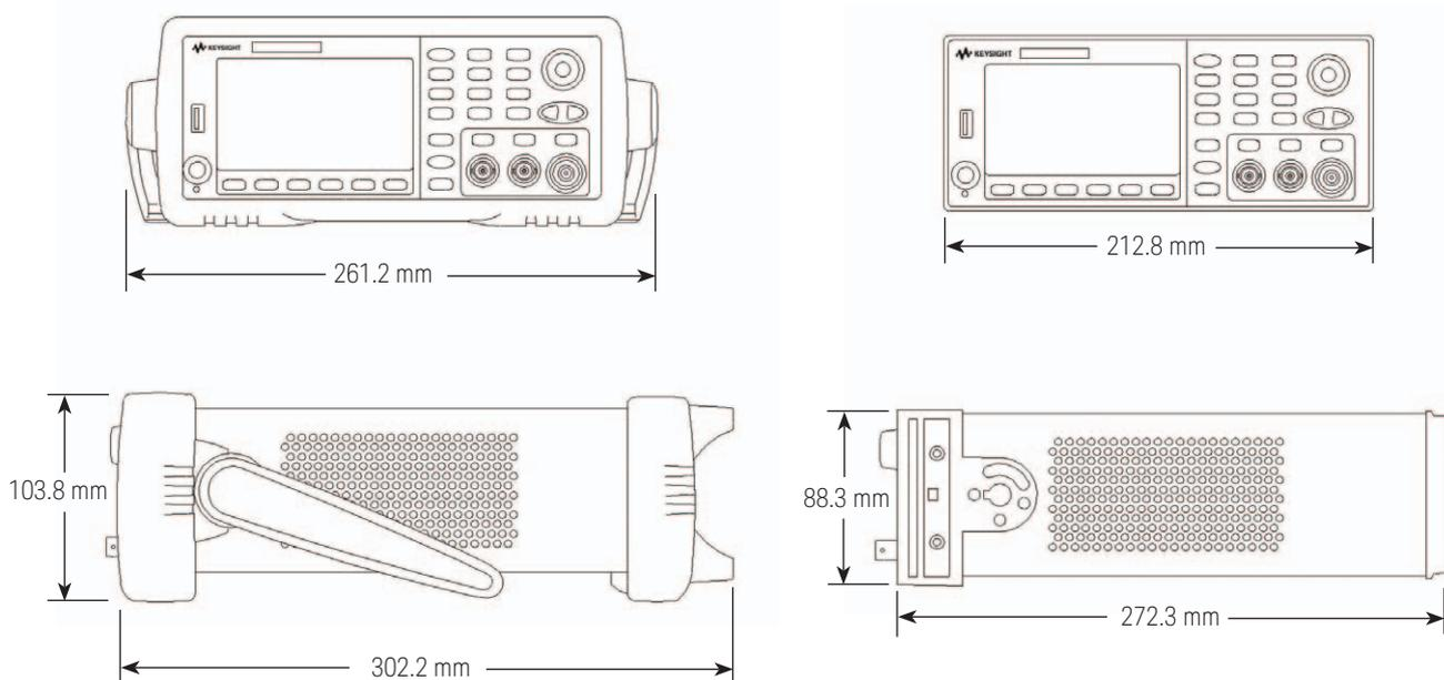
寸法は3種類のモデルすべてに適用されます：53210A、53220A、53230A。
