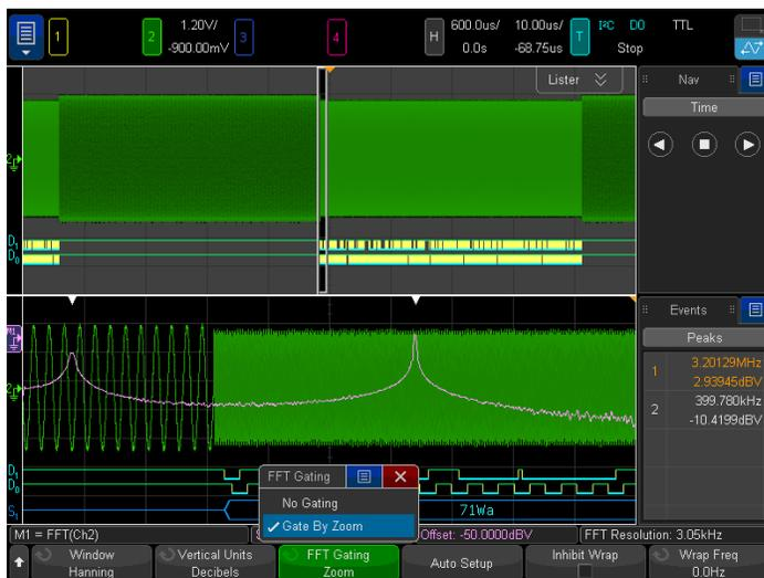
図18. ゲーティッドFFTにより、FSK変調のホッピングと、アナログ信号/I<sup>2</sup>C制御コマンドを適切に相関させることができます。
