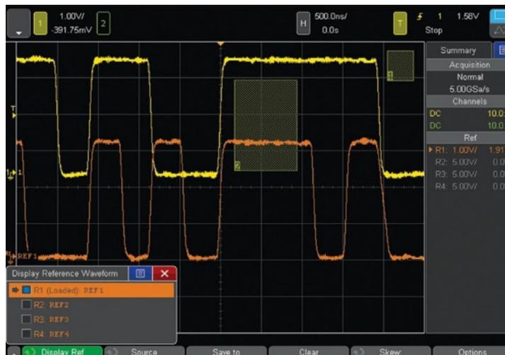
図33. 最大4個の基準波形の保存およびリコール。
