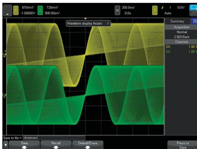
図42. 「ディスプレイ固定」機能は、波形収集停止中の輝度階調情報を保持します。
