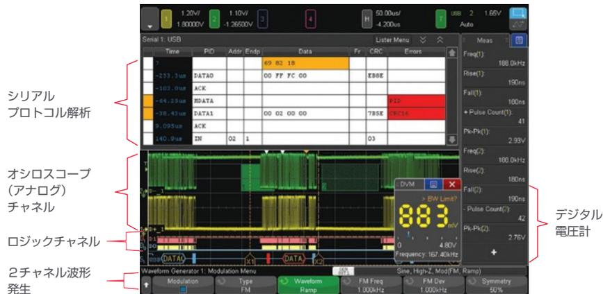
図17. 4000 X-シリーズは、7種類の測定機能をシームレスに1台の測定器に統合しています。
