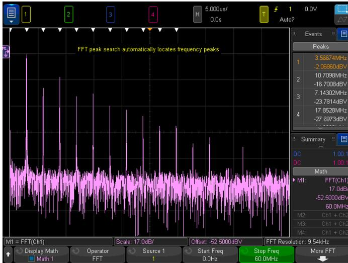
図10b. 4000 X-シリーズは、クロック信号を捕捉してFFT解析できるようにセットアップされています。サーチ&ナビゲーション機能では白色の▽マークを使用して、最初の11個の周波数ピークを検出し迅速に移動できます。周波数順または振幅順での移動も可能です。
