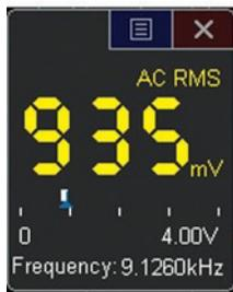
図25. いつでも使用できるDVM 3桁電圧測定と5桁周波数測定。
