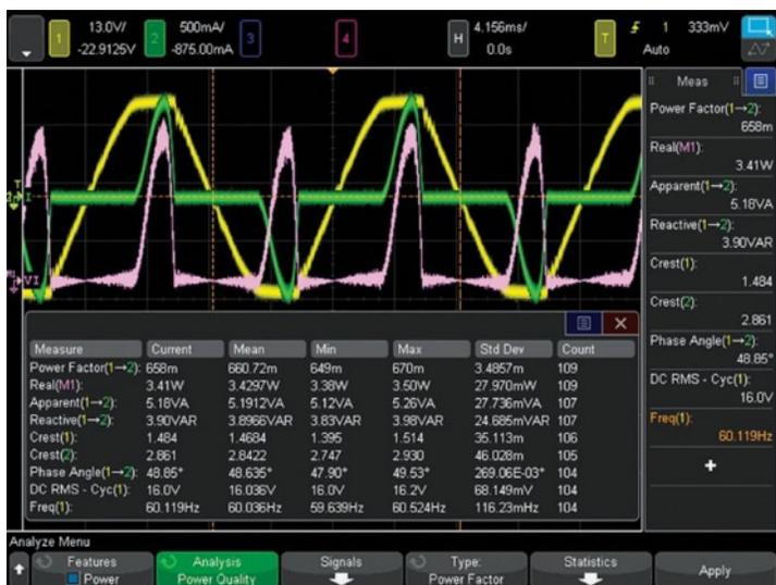
図26. パワー品質測定（多くのパワー測定アプリケーションのうちの1つ）。
