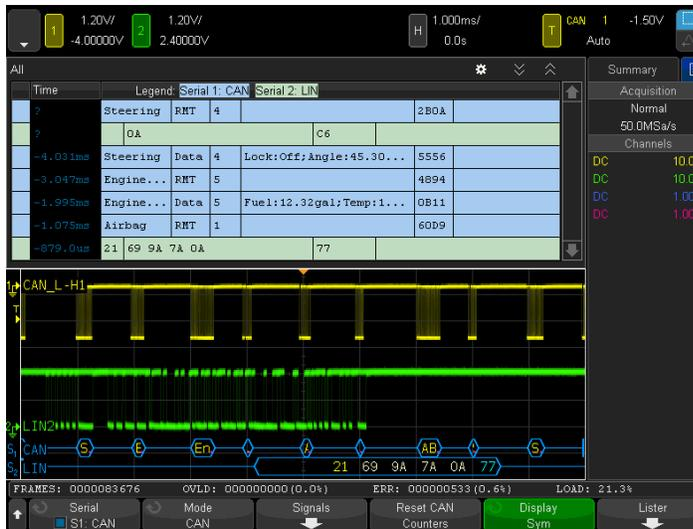
図20. CANとLINの2つのシリアル・バスを同時にデコードし時系列でリスト表示された「リスター」画面
