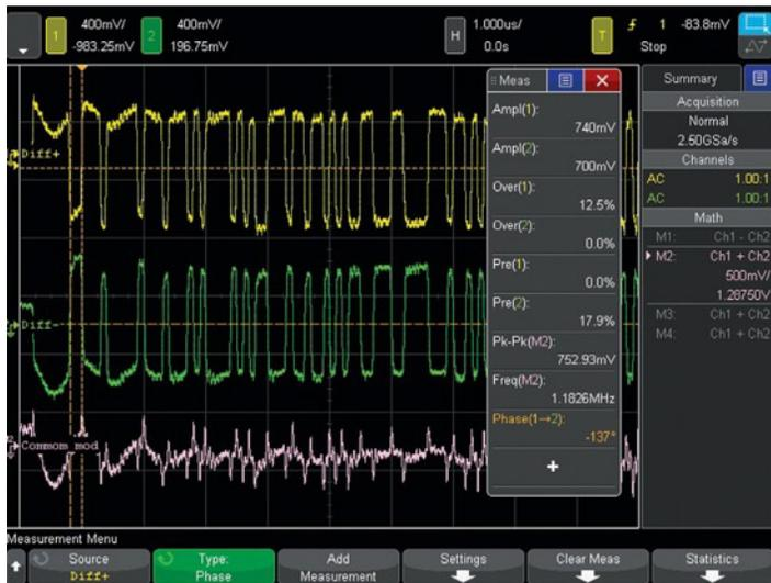
図24. 差動任意信号のデュアルチャンネル出力。コモンモードは演算として示されています。
