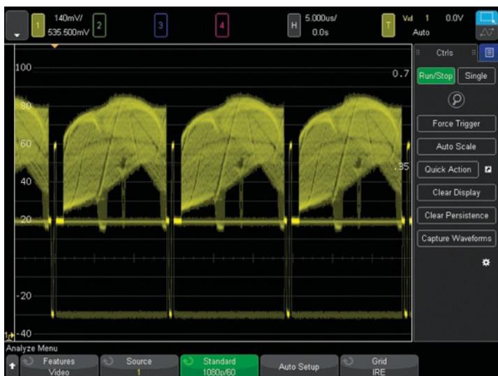
図27. 1080p HDTV信号解析のトリガ。
